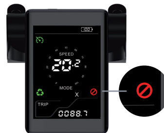
Le code d'erreur est actif, la valeur apparaîtra dans la section A, les détails seront expliqués dans le tableau des codes d'erreur page 59
